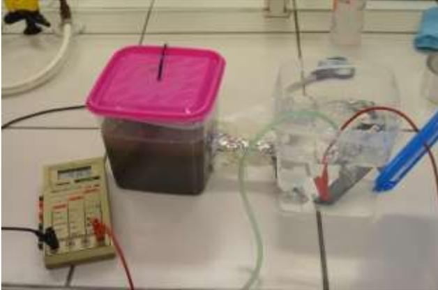
Avec un bulleur et à une température de 19,5 °C, la fem de cette pile vaut  $E_2 = 75 \text{ mV}$  et sa résistance interne vaut  $r_2 = 60 \text{ k}\Omega$ . La puissance électrique maximale que peut délivrer cette pile vaut  $P_{\text{max}2} = 0,013 \text{ }\mu\text{W}$ .
