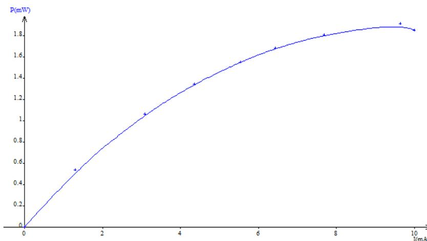
La puissance électrique fournie par cette pile vaut  $P = U \times I$  et on note que la puissance électrique maximale que peut fournir cette biopile vaut  $P_{\max 1} = 1,91 \text{ mW}$ .
