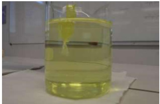
Fig 4 : la solution aqueuse d'hexacyanoferrate (III) de potassium a migré à travers la membrane
