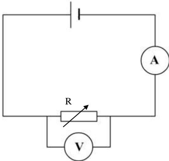
En faisant varier R, nous relevons les couples de mesures (I, U) puis nous traçons la caractéristique  $U = f(I)$  de ce générateur ainsi que la courbe de puissance  $P_{él} = R \times I^2 = f(I)$ .
