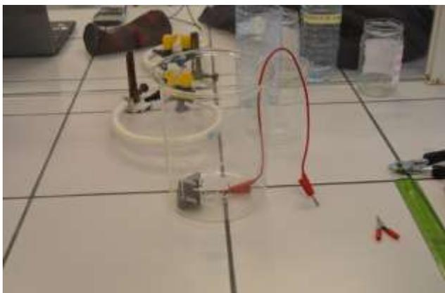
Fig 5 : tressage métallique jouant le rôle d'électrode
