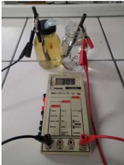
Fig 16 : pile avec de l'urine à l'anode
