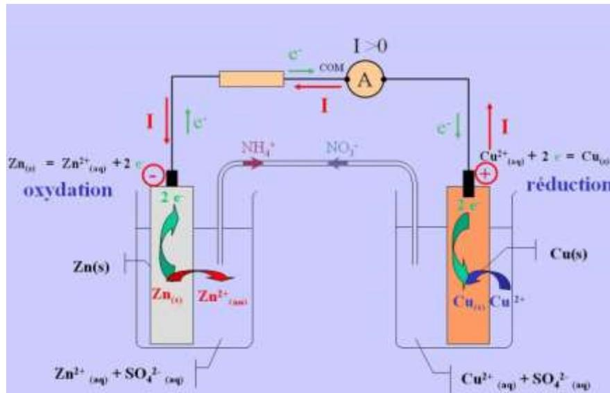
Fig 1 : schéma du fonctionnement d'une pile
