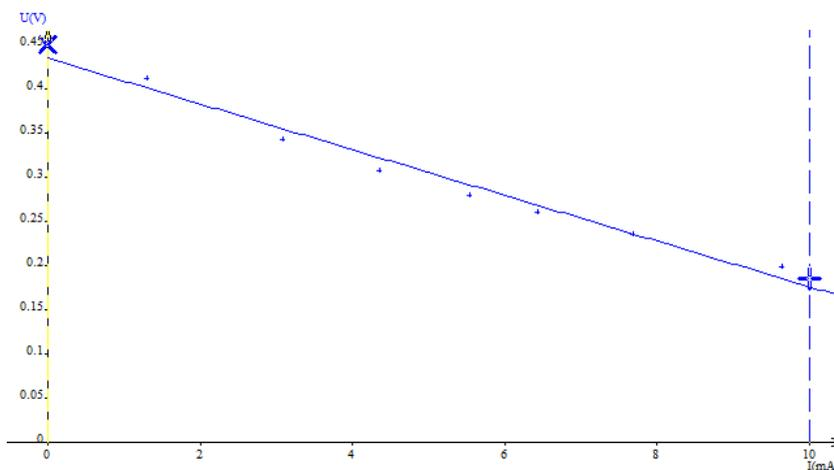
La force électromotrice de cette pile vaut  $E_1 = 435 \text{ mV}$  ; sa résistance électrique interne vaut  $r_1 = 26 \Omega$ .
