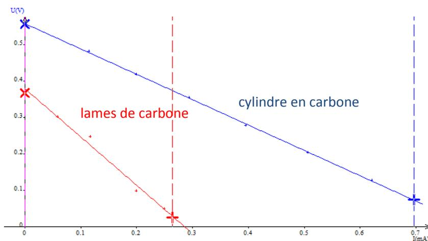
Avec des lames de carbone, la fem de cette pile vaut  $E_3 = 379 \text{ mV}$  ; sa résistance électrique interne vaut  $r_3 = 1,3 \text{ k}\Omega$ .
