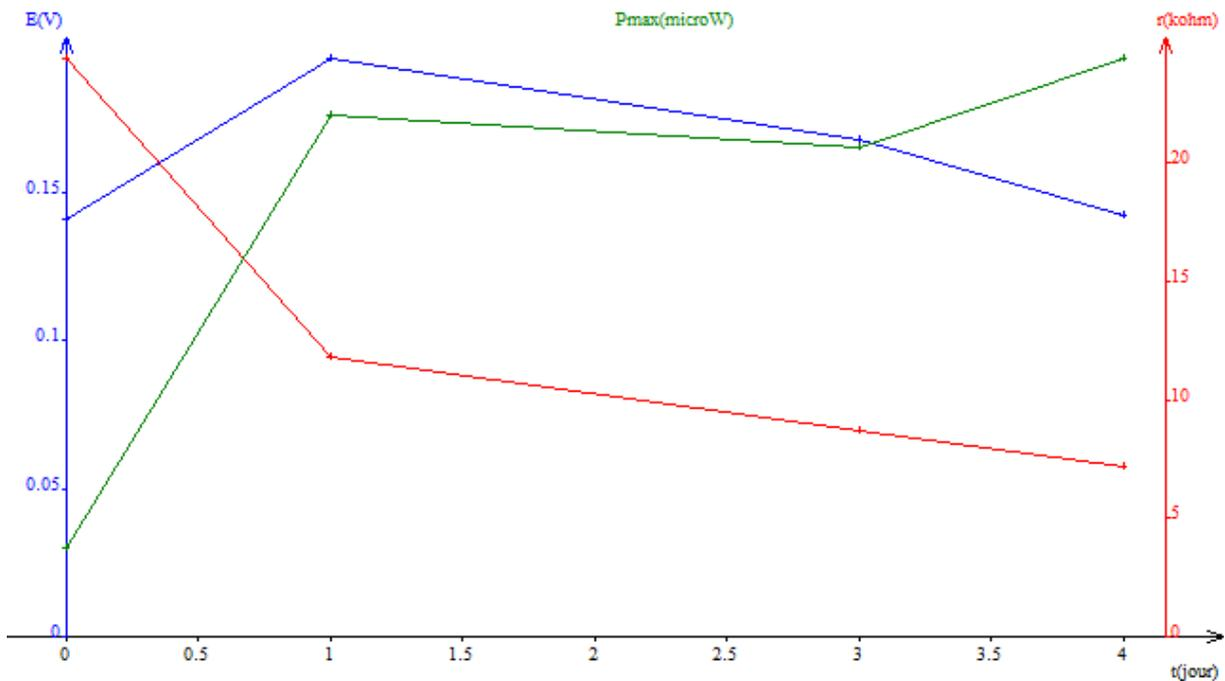
Nous observons qu'au bout de 24 heures, la pile atteint une bonne efficacité : c'est le temps nécessaire pour que le biofilm se forme sur l'anode et ensuite la pile garde quasiment le même comportement : le recouvrement de l'anode constant les 3 jours suivants.
