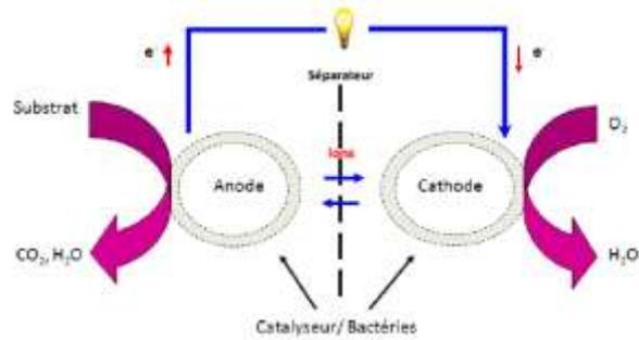
Fig 2 : Schéma d'une pile à combustible microbienne
